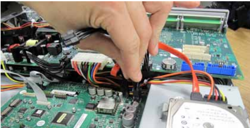
Figure 48: Attach Power cable to AMB
