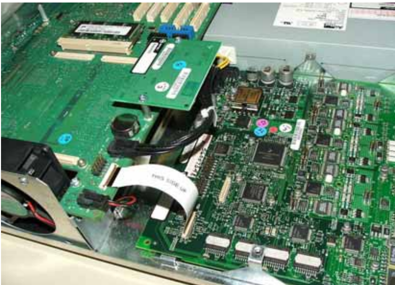
Figure 43: CX/CXi AMB ribbon cable
