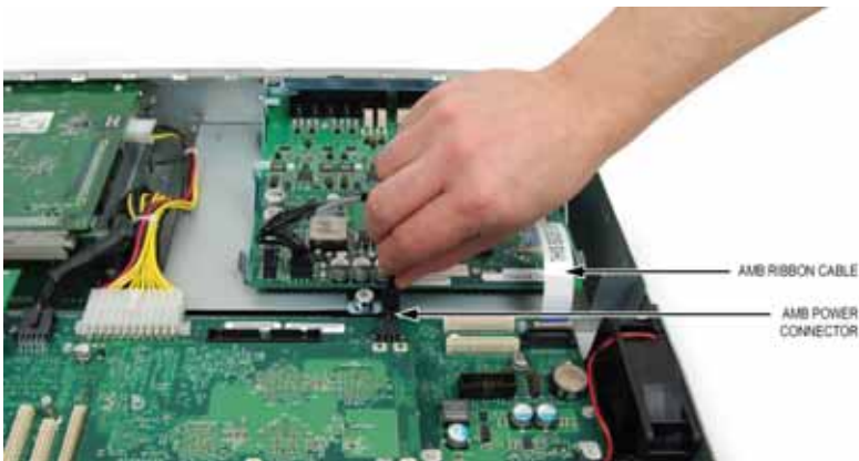
Figure 32: Disconnecting the AMB Power Connector
